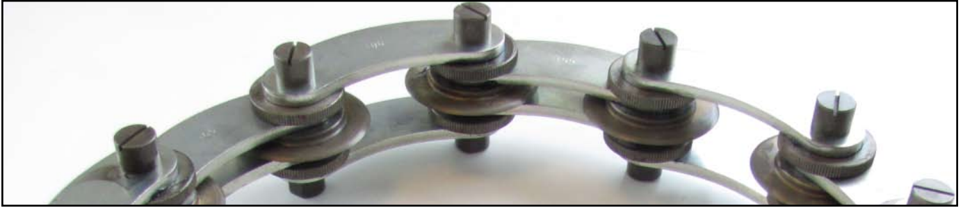
Närbild av kedjan på ett verktyg av typen DS
