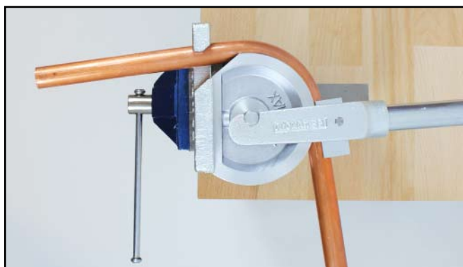
Bockverktyg Nr 30 22 mm i ett skruvstycke
