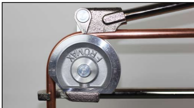
Bockverktyg Nr 55 15 mm
